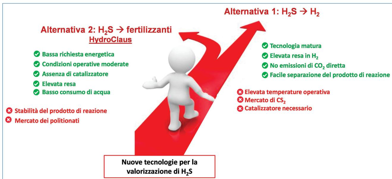
Fig. 4 - Pro e contro delle tecnologie di valorizzazione di H<sub>2</sub>S analizzate
