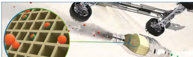
Fig. 3 - Schema di una marmitta catalitica con un ingrandimento della struttura alveolare che supporta il catalizzatore.
