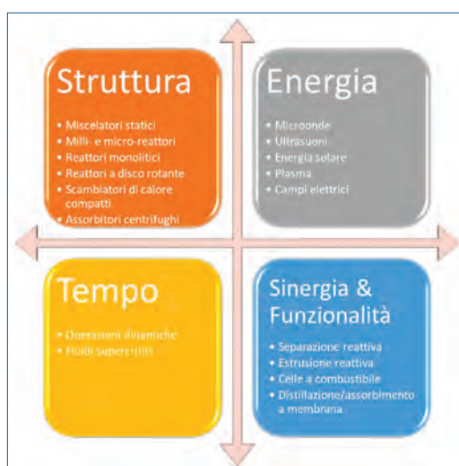
Fig. 1 - Definizione dei concetti principali dell'intensificazione di processo. Adattato da Haase et al. 2022 [7]
